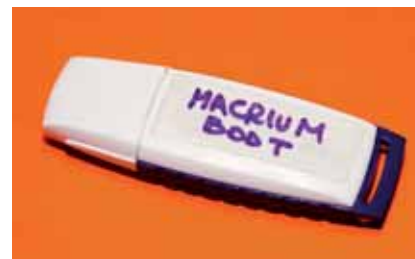
Figura 11 - Una sola chiavetta di avvio di emergenza, realizzata con Reflect, può essere usata su più computer. Chi ha versioni di Windows sia a 32 che 64 bit, necessita di due chiavette distinte.
