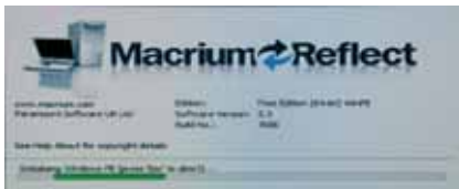
Figura 5 - Finestra di avvio del Restore di Macrium Reflect. Sopra la barra verde c'è la scritta Installing Windows PE , il sistema operativo ridottissimo contenente tutto quello che serve: gestione della tastiera, del mouse e delle porte USB, nonché Windows Explorer per navigare tra le cartelle.
