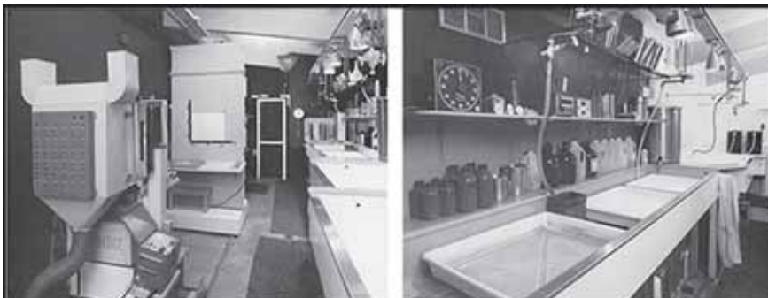
Figura 2 - Camera oscura di Adams. Entrati dalla porta in basso, a sinistra c'era l'ingranditore disteso in orizzontale e scorrevole su un binario disteso a terra. Accettava lastre 8x10 pollici e proiettava immagini su un supporto rigido verticale, anch'esso scorrevole lungo il binario. Allontanando l'ingranditore dal supporto verticale della carta, si aumentava l'ingrandimento. Adams vi faceva stampe fino a 20x24 pollici. Memore delle disavventure passate in una precedente camera oscura (un terremoto vi provocò un crollo e lui rischiò la vita), Adams qui prevede una porta di emergenza, a sinistra
